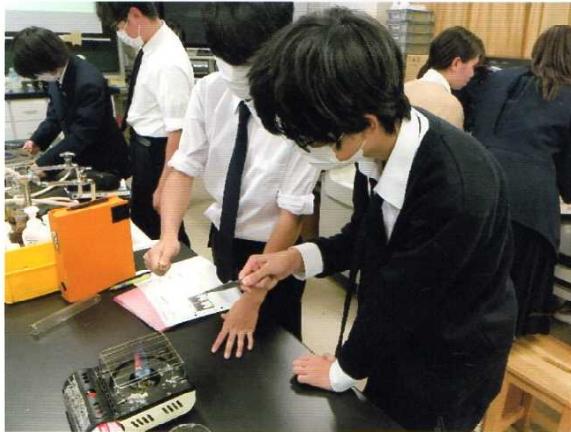
写真② 熱でやわらかくなった PET を引っ張って糸にしている。
