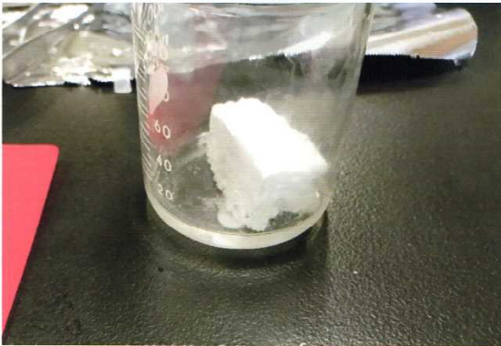
写真⑤ 発泡スチロール（PS）はアセトンでペースト状になる。
