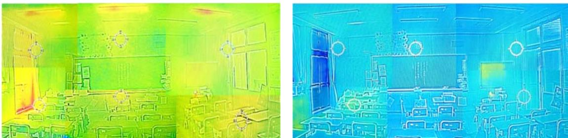
図 5-23 ナイトパーズ装置開サーモグラフィ (左: 測定開始時, 右: 測定終了時)
