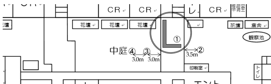
図5-19 水道直結型ドライミスト装置と温湿度の平面位置関係
