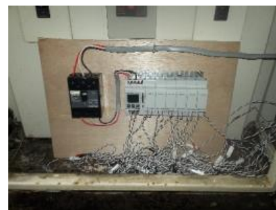
キュービクル内の電圧・電流計測の様子
