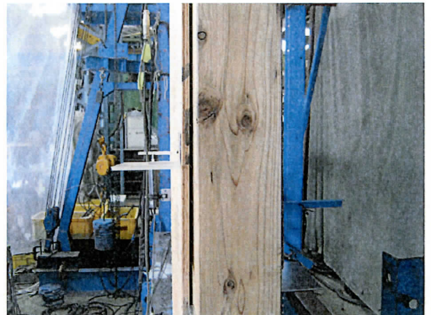
写真-4 破壊状況 番号:2 P_{max}=85.1\text{kN} ・面材くぎの抜け
