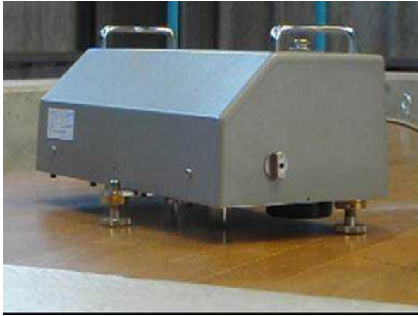
写真 1.2.2.1 軽量衝撃源 (タッピングマシン)
