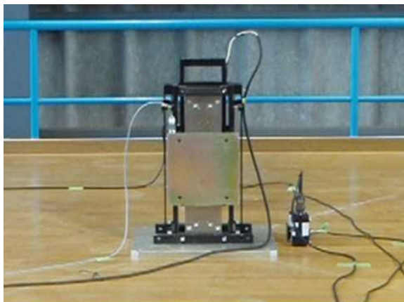
写真 1.2.3.1 起震機を使った床の振動実験
