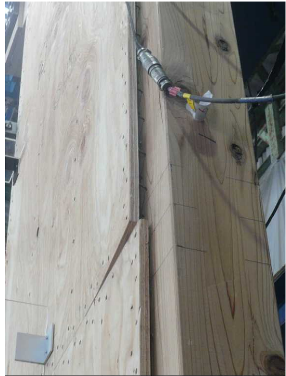
写真 2.2.2.2 破壊状況（左：耐力壁の変形の様子と右：面材釘の引き抜け）
