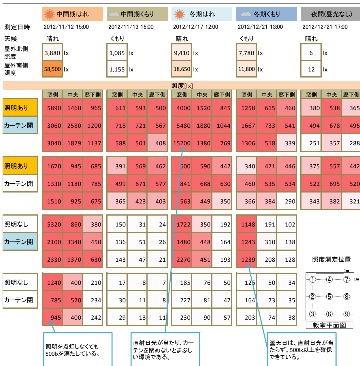
図 3-36 中間階普通教室の机上面照度
