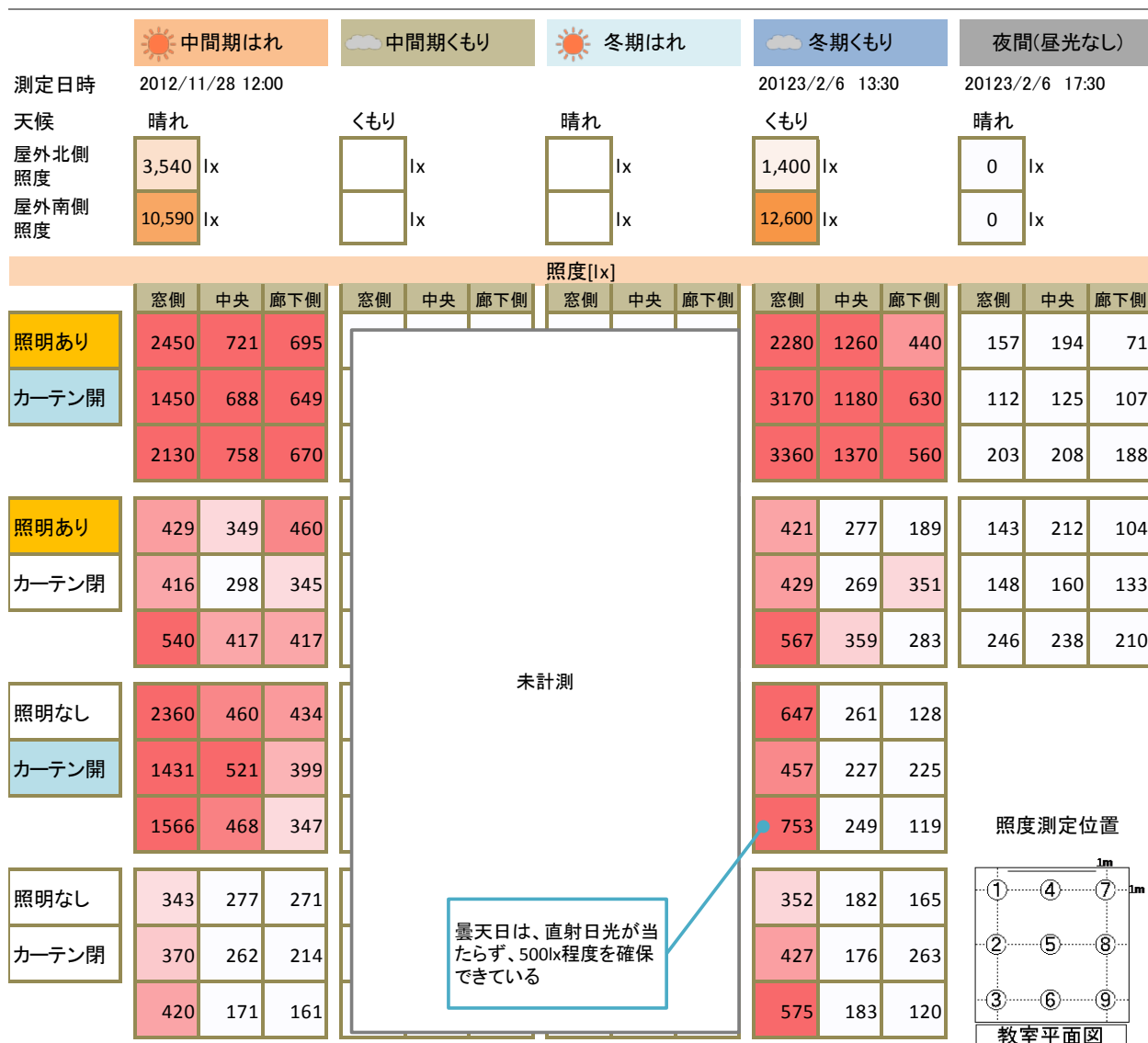
図 4-34 中間階普通教室の机上面照度
